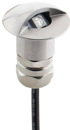
El Foco POD RGB es una baliza LED para empotra en acero inoxidable. Spot de exterior de mínimo tamaño y máxima calidad. Fabricado en acero inoxidable 316 y chip led CREE. Permite su instalación en cualquier lugar. Alto índice de reproducción cromática (CRI) y fuerte grado de protección IP68.
